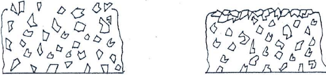
Figura 16. Rappresentazione schematica della superficie del vetro prima della lucidatura (a sinistra) e dopo la lucidatura (a destra).
