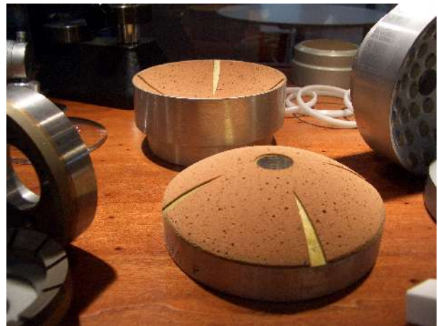
Figura 14. Coppia di patine per la lucidatura automatica, con pellicola di resina poliuretanaica.
