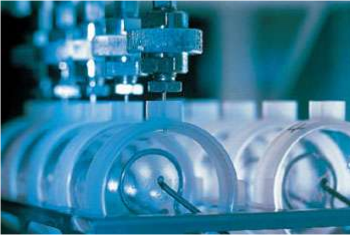
Figura 16. Produzione di lenti in materiale termoindurente: iniezione del monomero negli stampi. Normalmente le aziende realizzano produzioni in serie lavorando contemporaneamente un grande numero di lenti.
