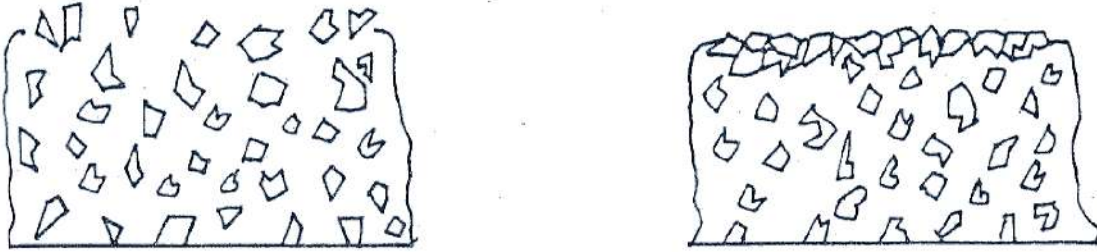
Figura 22. Rappresentazione schematica della superficie del vetro prima della lucidatura (a sinistra) e dopo la lucidatura (a destra).
