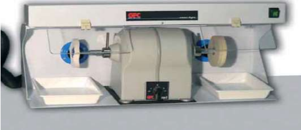
Figura 23. Lucidatrice per la finitura del bordo delle lenti.
