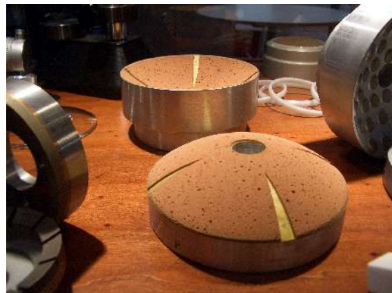
Figura 14. Coppia di patine per la lucidatura automatica, con pellicola di resina poliuretana.
